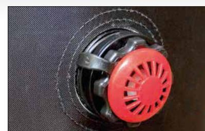
Jedes Überdruckventil sollte vor dem Aufpumpen auf Funktion überprüft werden. Dazu schrauben Sie das Gehäuse aus der Fassung und überprüfen ob sich die Feder eindrücken lässt. Stellen Sie sicher, dass das Ventil nach dem Test wieder richtig verschlossen wird.
